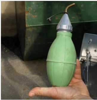
Pulverapparater er små og hendige, men pulver kommer lett på avveie og gir uønsket gifteksposering.
